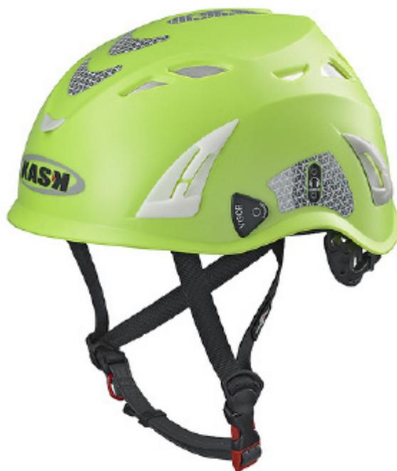
Ce nouveau casque hi-tech a été spécialement conçu pour les professionnels travaillant autant au sol que dans les airs. Il est léger, compact, confortable et bénéficie d'une excellente ventilation. Sa coque externe en terpolymère ABS haute densité est conçue pour résister aux impacts selon les normes CE EN 12492 (alpinisme) et CE EN 397 (industrie). Son rembourrage intérieur en Polygiene offre un confort maximum et une absorption rapide de l'humidité.
