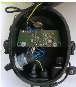
Intégration d'un amplificateur de microphone dans la coquille pour une meilleure émission.
