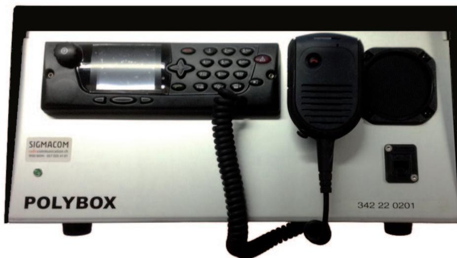
Coffret de table permettant de mettre un mobile BER TPM700 en station fixe, comprenant une alimentation, une batterie de secours, un HP auxiliaire un monophone et un connecteur d'antenne de type UHF femelle.
