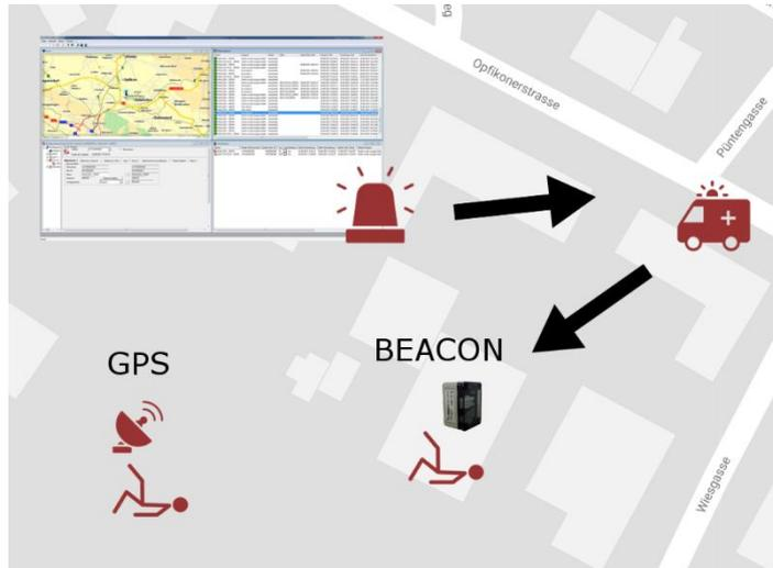
Das kleine, robuste und leicht zu bedienende SHALOSH ECO erkennt vier potentiell gefährliche Situationen automatisch – zusätzlich kann der Alleinarbeiter mit dem blind bedienbaren Alarmknopf bewusst Hilfe anfordern.
