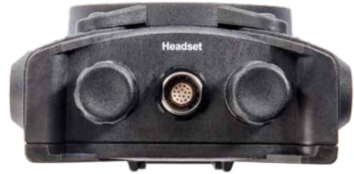
! Les CT-MultiPTT sont équipés de connecteurs extrêmement robustes avec une fonction de rupture (fonction de déverrouillage d'urgence), qui se déverrouille à une force de traction définie en cas d'urgence.
